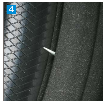
4 特殊吸音スポンジを貫通させ、傷穴の方向を内側からも確認する
