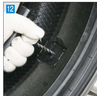
12 スパイラルリーマーに加硫剤を塗り内側から挿入し、傷穴の清掃と方向確認をする
