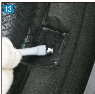
13 バフがけをした面に加硫剤を薄く均等に塗る
