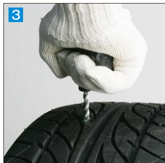
3 スパイラルリーマーをタイヤの外側から挿入し、傷穴の方向を確認する
